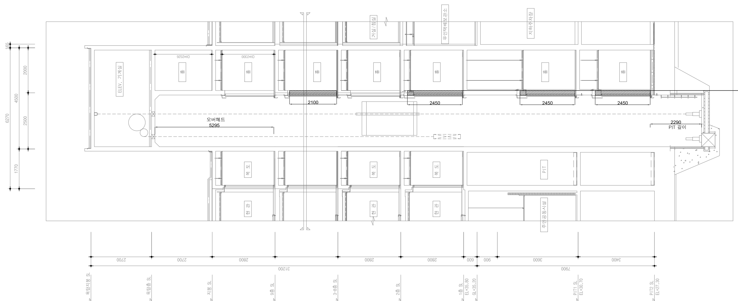
승강로 단면 및 출입문 설치도-1 SCALE : 1/50(A3:1/100)
